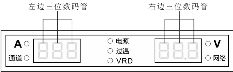
图 4-1 故障代码显示
